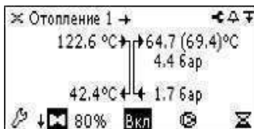
Рис. 24. Пример ручного управления клапаном и циркуляционным насосом СО1
